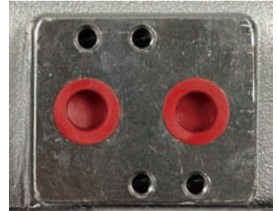
标准气源接口/Air connection
